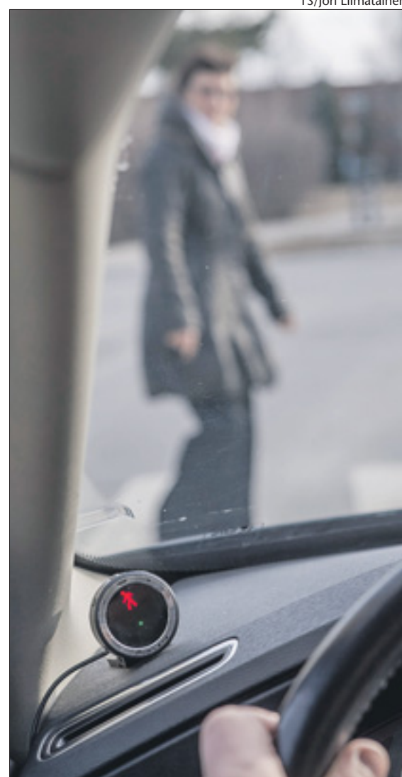
Ylijohvaroitin varoittaa uhkaavasta törmäyksestä kuljettajaa sumerilla ja kuvakkeella.
